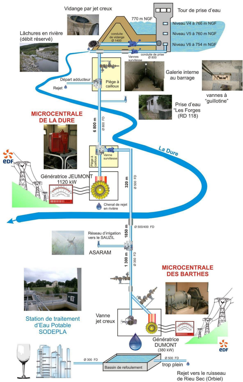
Synoptique des infrastructures du barrage
